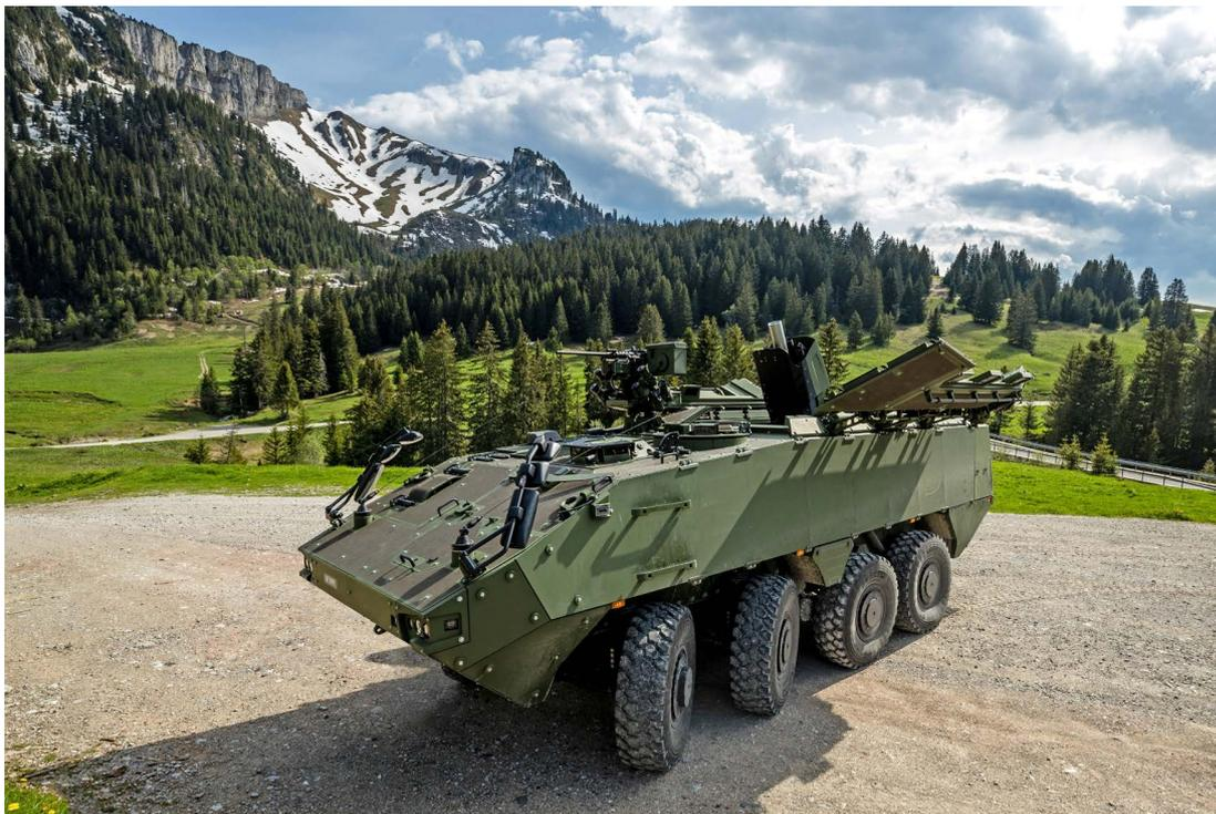
Bild 1: Panzermörser 16 mit geöffneten Geschützraum-Deckeln
