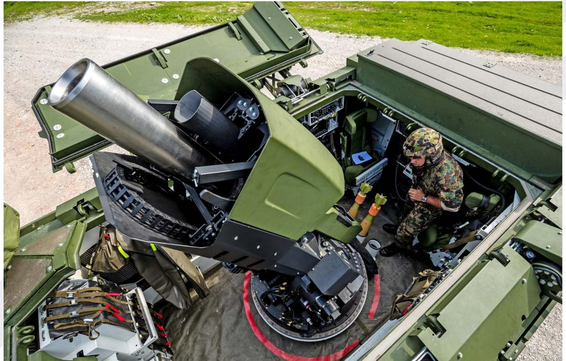
**Bild 2: Mörser «Cobra» mit Ladevorrichtung, aber ohne «Rohrdeckelautomat» zur Verhinderung von Wasser im Rohr aufgrund von Regen oder Schneefall**
