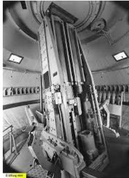
Der 12 cm Fest Mw ist ein ortsfest - in der Regel in einem Monoblock eingebautes Doppelrohr-Hinterladergeschütz mit einer halbautomatischen pneumatischen Ladevorrichtung. Diese ermöglicht eine Kadenz bis zu 20 Schuss/Min.
