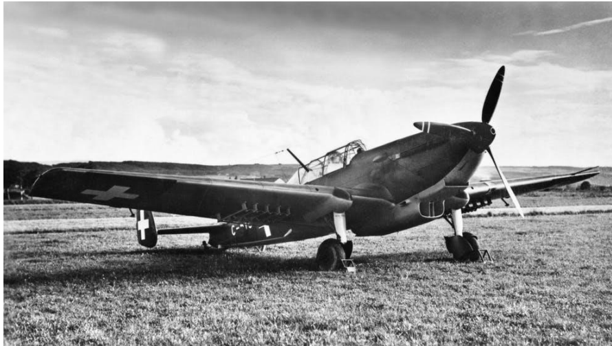
Abbildung 50: 1942 wird auf dem „ Militärflugplatz Dübendorf “ eine C-36 der Schweizer Flugwaffe, die 1939 in Thun ihren Erstflug absolviert hatte, mit einem von Ackeret konzipierten Verstellpropeller umgerüstet
